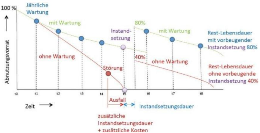
Um den gesicherten Betrieb Ihrer Anlage aufrecht zu erhalten ist eine regelmässige Wartung unumgänglich. Aus diesem Grund empfiehlt jeder Gerätehersteller einen bis zwei **Filterwechsel** jährlich sowie eine **jährliche Wartung**. Zudem sichert die Durchführung von periodischen Wartungs- und Servicearbeiten die **Gewährleistung der Energieeffizienz**.
